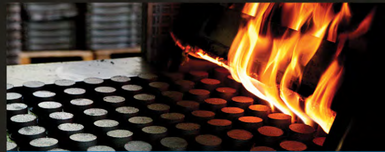
Phase de cuisson de plots pour le ferroviaire Baking phase of the railway pads
